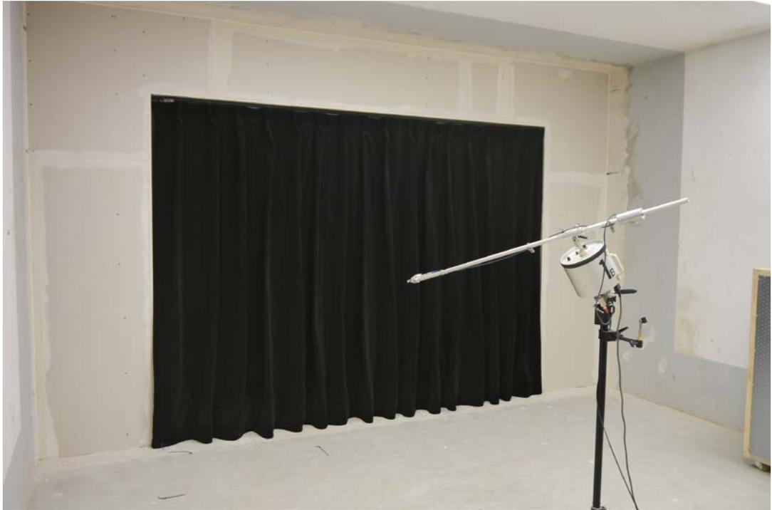
Foto 1. Mehrlagiger Trennvorhang, eingebaut im Wandprüfstand; für die orientierenden Schallabsorptionsgrad-Messungen wurden sämtliche Zusatzabsorber aus dem Raum entfernt.
