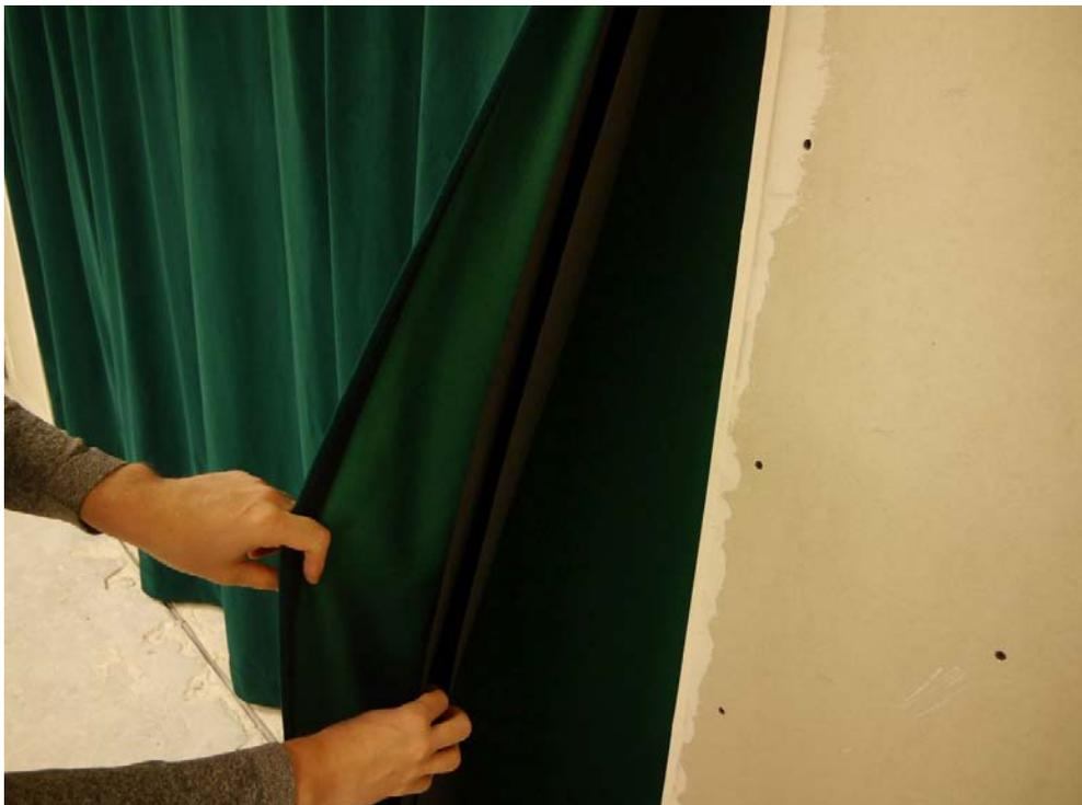
Abbildung B.6. Prüfaufbau Variante 2 im Wandprüfstand: Innenlage 2-lagig.
