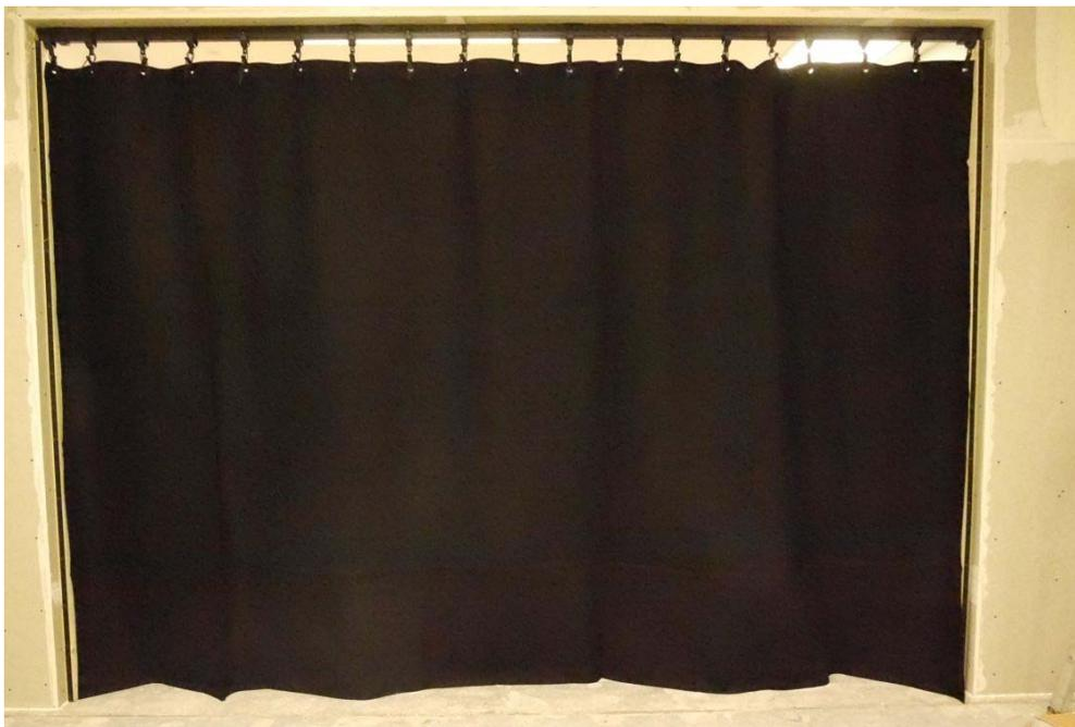
Abbildung B.2. Prüfaufbau während der Montage: Gesamtansicht Vorhangschiene mit Laufwägen und eingehängter Innenlage.
