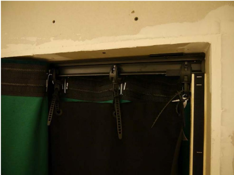
Abbildung B.3. Prüfaufbau im Wandprüfstand: Detail Ecke oben mit aufgeklappter Decklage; Aufhängung von Innen- und Decklage an den Laufwägen; seitlicher Anschluss Decklage an Holzlatte.
