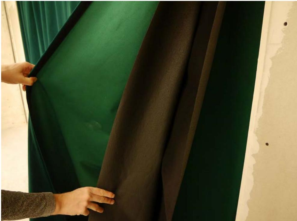
Abbildung B.5. Prüfaufbau Variante 1 im Wandprüfstand: Innenlage 1-lagig.
