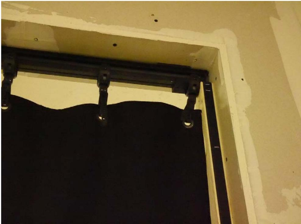
Abbildung B.1. Prüfaufbau während der Montage: Vorhangschiene mit Laufwägen und eingehängter Innenlage; seitlich Holzlatte mit Klettband für den seitlichen Anschluss der Decklagen.
