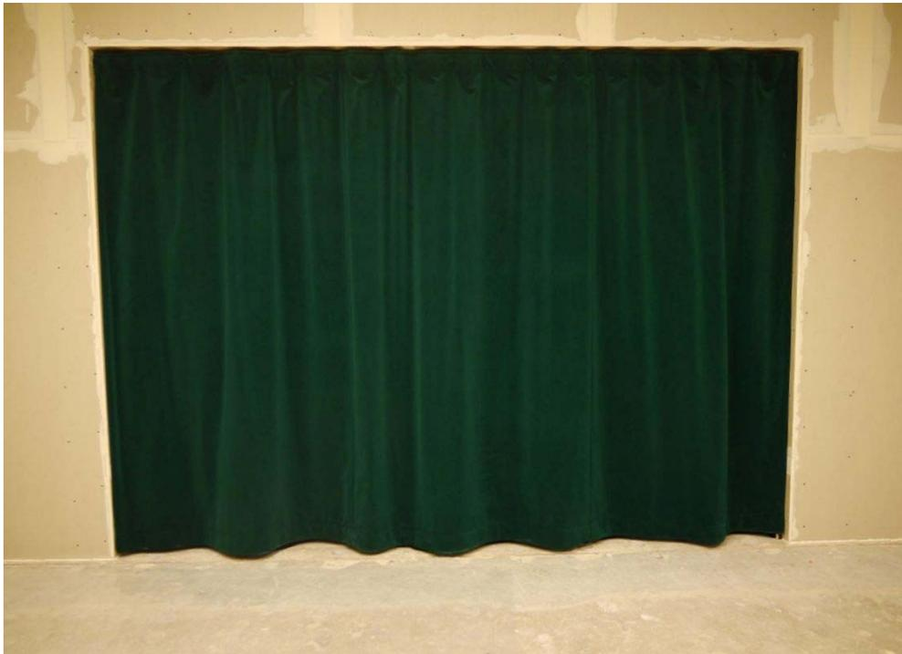
Abbildung B.7. Prüfaufbau im Wandprüfstand: Gesamtansicht senderraumseitig (prüffertig).
