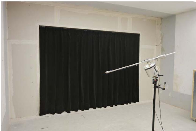
Abbildung B.6. Mehrlagiger Trennvorhang mit 100 % Faltenzugabe in den Außenlagen.
