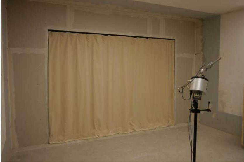
Abbildung B.1. Mehrlagiger Trennvorhang (Versuch 1) im Wandprüfstand.
