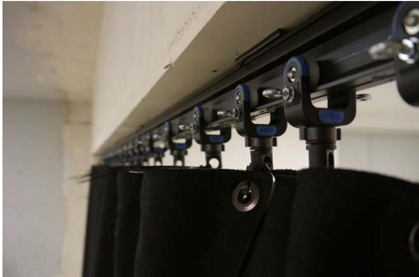
Abbildung B.5. Vorhangsschiene mit eingehängter Mittellage ohne Decklagen. Erkennbar sind die seitlich an den Laufwagen vorhandenen Ösenaufnahmen, in die die Haken der Decklagen eingehängt werden können.
