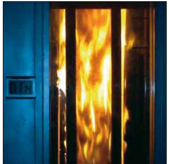
Ensayo de horno según DIN 4102-1, ensayo negativo
